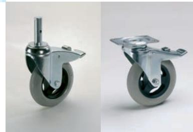
Rostgeschützte Rolle mit Kunststoffrad und luftidentischer Lauffläche, kugellagert in verzinkt-chromatisiertem Gehäuse. Dieser Rollentyp sorgt für minimale Fahrgeräusche und ist besonders für unebene Fahrwege geeignet.
